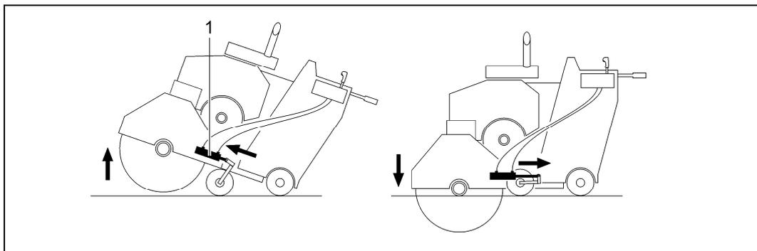
Accionamiento elevador (esquemáticamente)
