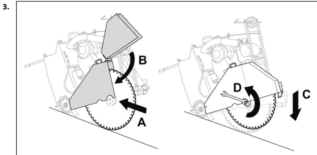
C: Para evitar que el disco de corte gire al apretarlo, colocar el disco de corte cuidadosamente sobre el suelo.
