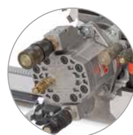
Moteur principal avec raccord d'huile de fuite
