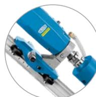
Utilisation universelle grâce à la capacité de réglage d'inclinaison 90°-45°
